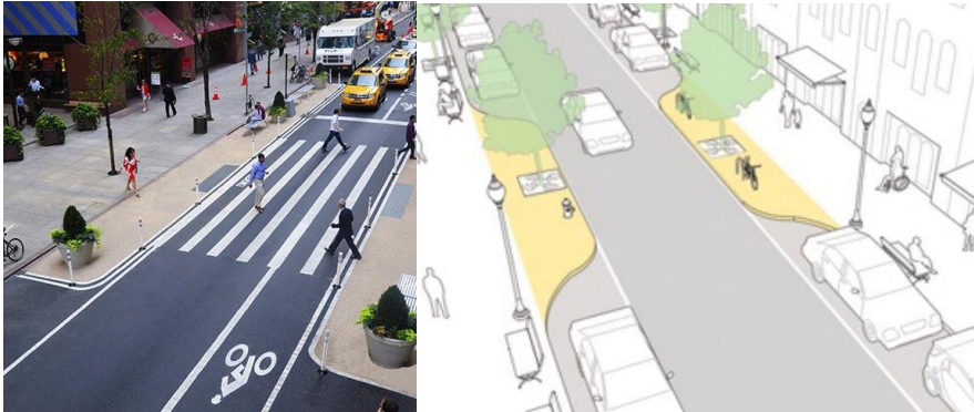
Incremento della visibilità del pedone in attraversamento per mezzo di avanzamento del marciapiede
