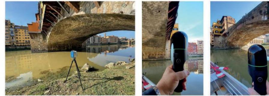
Fase di acquisizione dati metrico-morfologici delle sotto-arcate mediante strumentazione laser-scanner terrestre (Z+F Imager 5016) e mobile (Leica BLK2GO) basata su tecnologia SLAM (Simultaneous Localization And Mapping)
