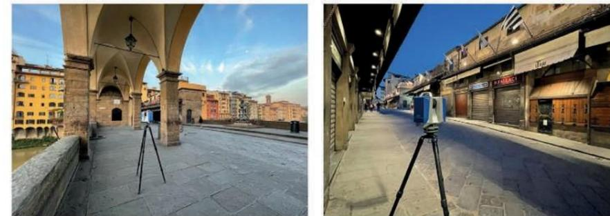
Fasi di acquisizione dati metrico-morfologici del selciato di Ponte Vecchio mediante strumentazione laser-scanner terrestre (Z+F Imager 5016)
