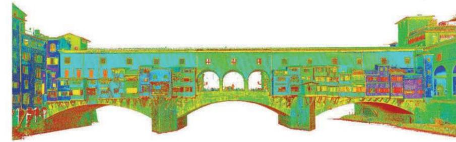
Vista prospettica della nuvola di punti globale elaborata dal rilievo laser-scanner, dalla cui base morfologica sono stati estratti i dati metrici per la realizzazione degli elaborati grafici tecnici
