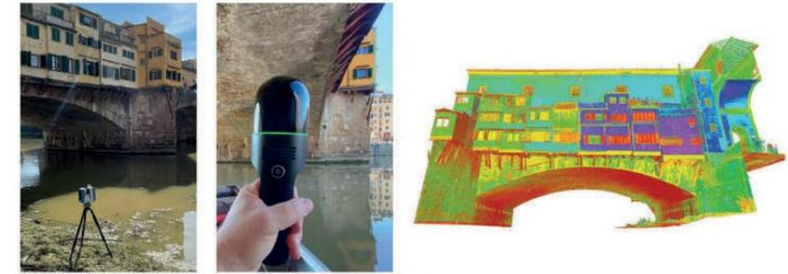
Fase di acquisizione dati metrico-morfologici dei prospetti delle pile della prima campata mediante strumentazione laser-scanner terrestre (Z+F Imager 5016) e mobile (Leica BLK2GO) basata su tecnologia SLAM (Simultaneous Localization And Mapping)
