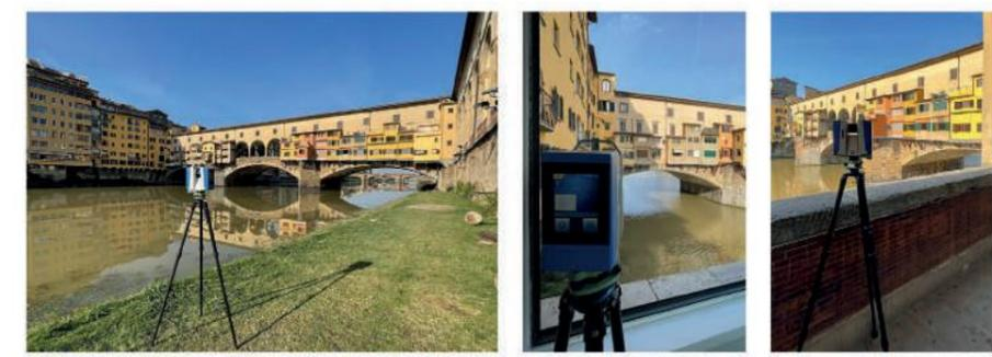
Fasi di acquisizione dati metrico-morfologici del prospetto est di Ponte Vecchio mediante strumentazione laser-scanner terrestre (Z+F Imager 5016)
